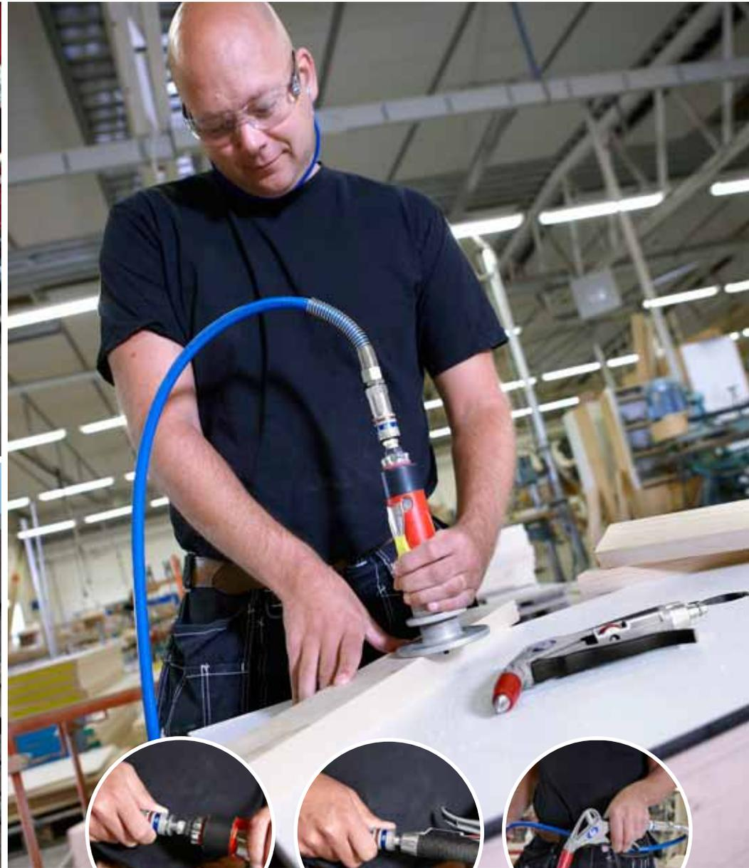
*O eSafe dá passagem à pressão antes da desconexão, reduzindo o nível de ruído e o risco de lesão ao operador durante a troca de ferramenta.*
